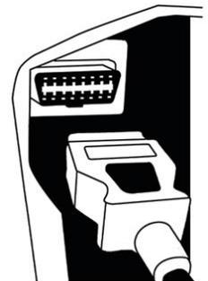
**Hinweis:** Die folgende Bildschirmmeldung wird angezeigt, wenn alle Sensoren ausgelöst wurden und das OBD2-Kabel an das **RDKS GERÄT** angeschlossen ist.
