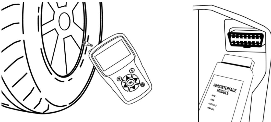
**Bitte beachten Sie:** Wenn sich das Fahrzeug im "Lernmodus" befindet, bestätigen einige Fahrzeuge durch eine Reihe von Pieptönen, dass die Sensorinformationen mit dem RDKS-System kommuniziert wurden.
